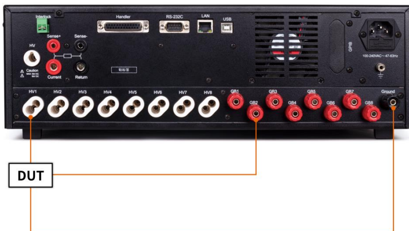
图 3-19-2 同步测试接线图
