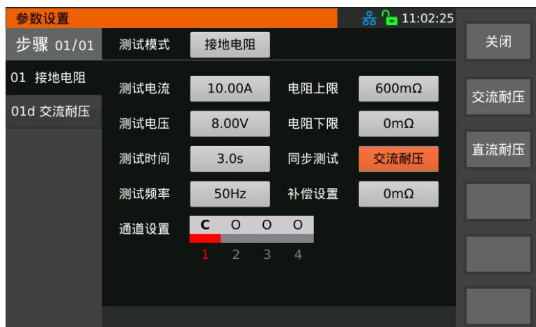
图 3-18 接地电阻同步测试设
