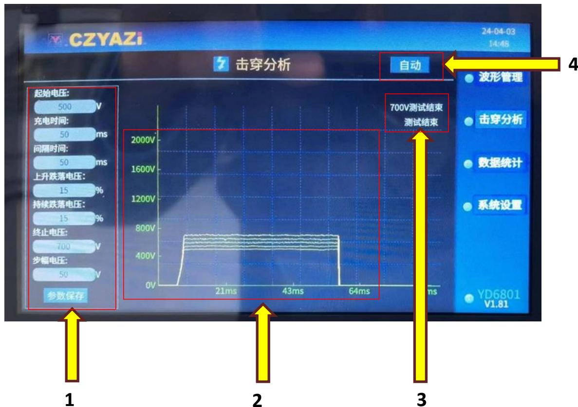
1. 参数区 - 用户可在该区域设置击穿用测试参数，包括起始电压、充电时间、间隔时间、上升跌落电压、持续跌落电压、步幅电压、终止电压：
