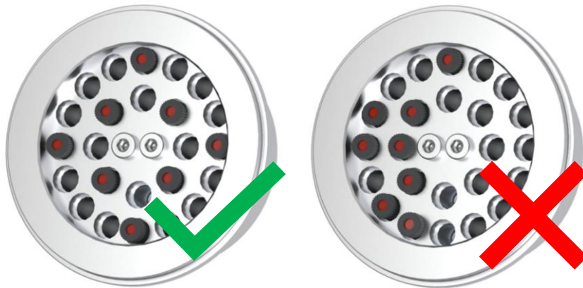
图66：适配器中玻璃容器允许的布置方式
