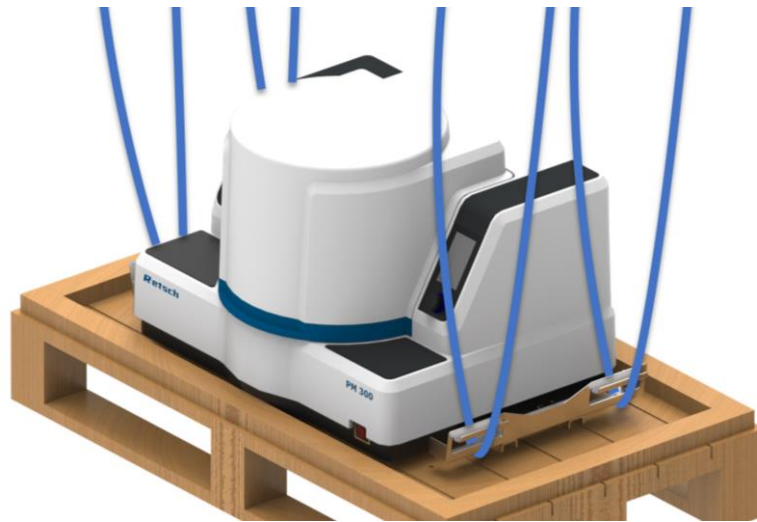
图17：用提升辅助装置和升降皮带运输
