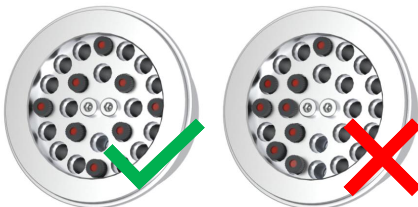
图32：适配器中玻璃容器允许的布置方式
