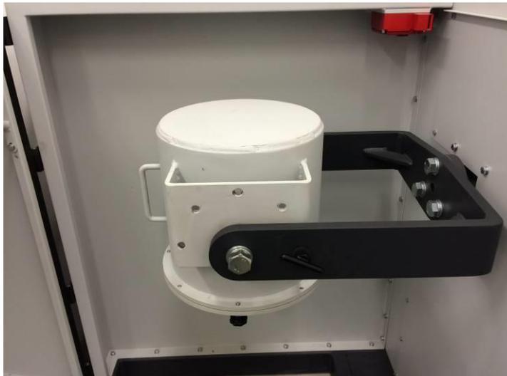
图25：研磨滚筒处于完全排空位置
