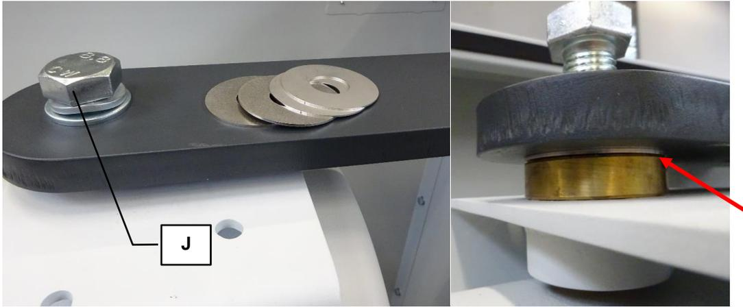
图11：补偿研磨滚筒与研磨滚筒架之间的缝隙
