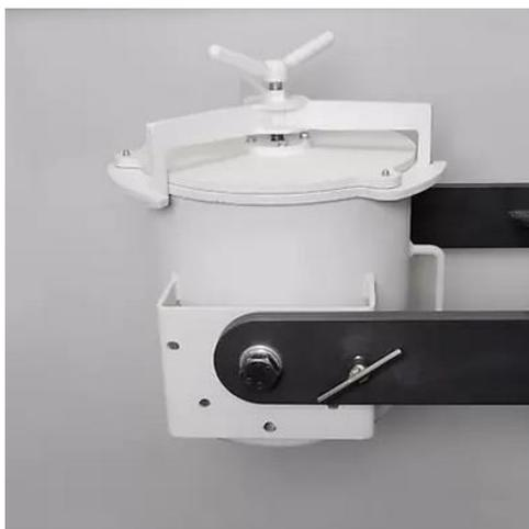
图19：盖子已关闭的研磨滚筒
