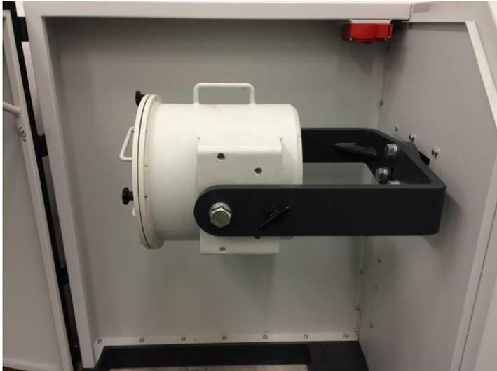
图23：研磨滚筒处于研磨位置
