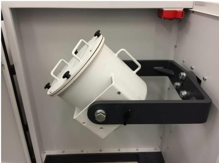
图22：研磨滚筒处于混合位置
