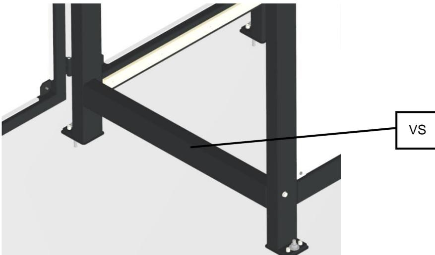
图5：加固支撑
