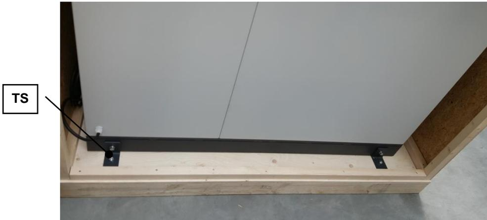
图4：将运输保险装置从运输托盘上松开
