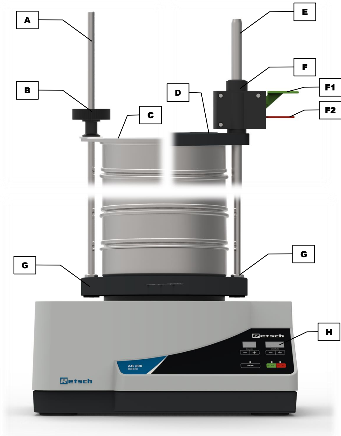
图8: 配有不同筛子夹紧单元的设备的前视图
