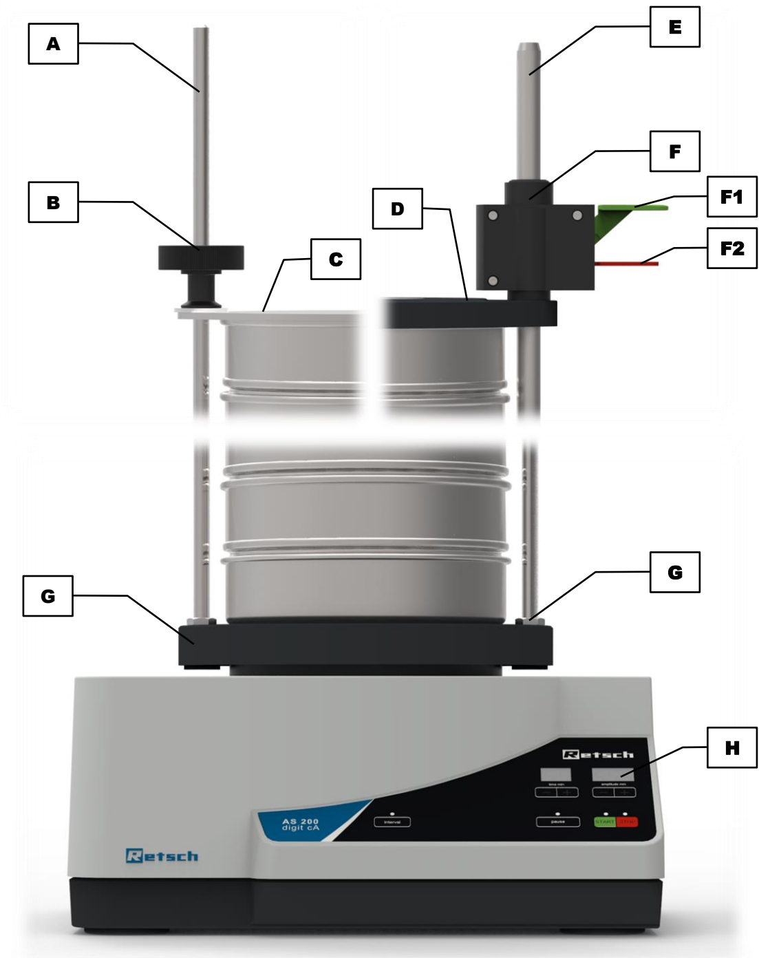
图8: 配有不同筛子夹紧单元的设备的正视图
