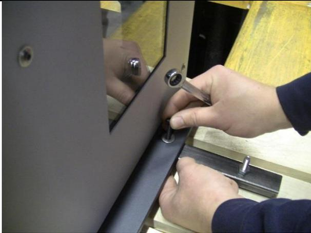
图4： 松开运输辅助装置上的螺栓
