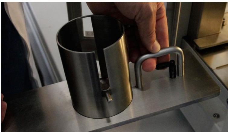
图39： 取出工具滑板
