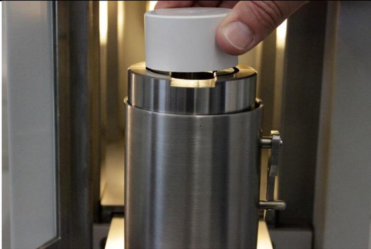
图18： 安放压出辅助工具
