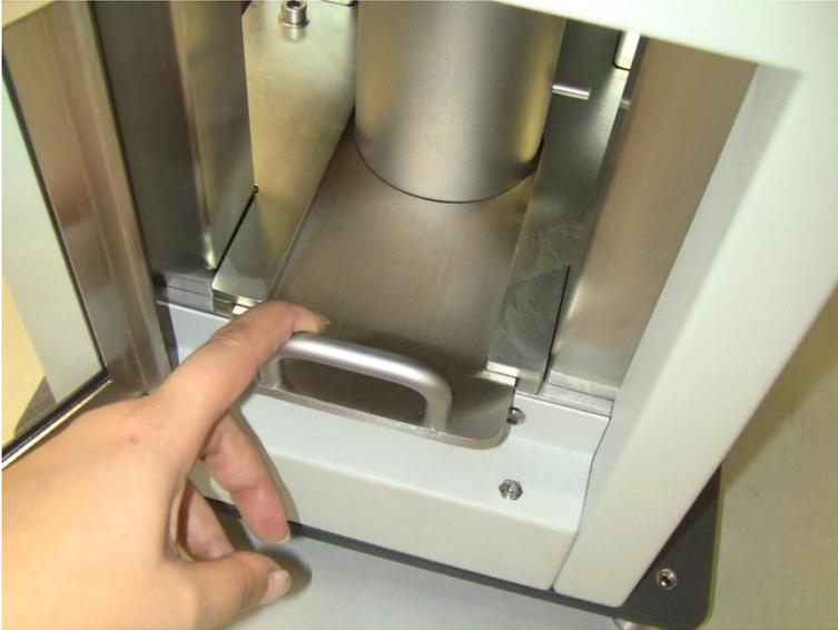
图8： 拉出工具滑板
