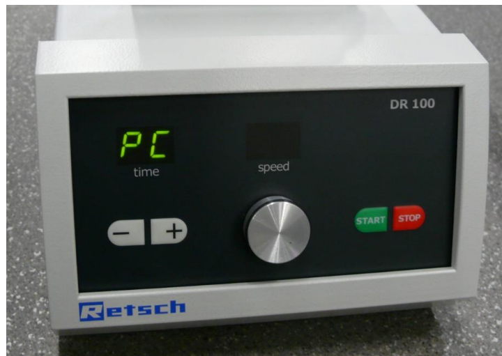
图30：通过 DM 300 控制时配料机的显示屏
