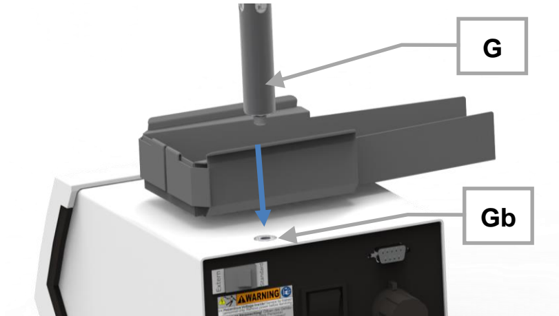
图13：安装漏斗固定架的连杆
