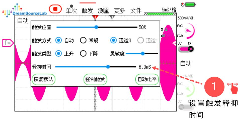
图 3-13 设置触发释抑时间
