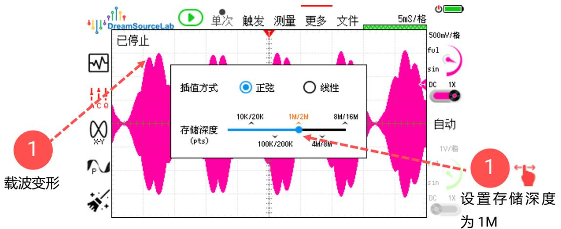
图 3-14 设置存储深度
