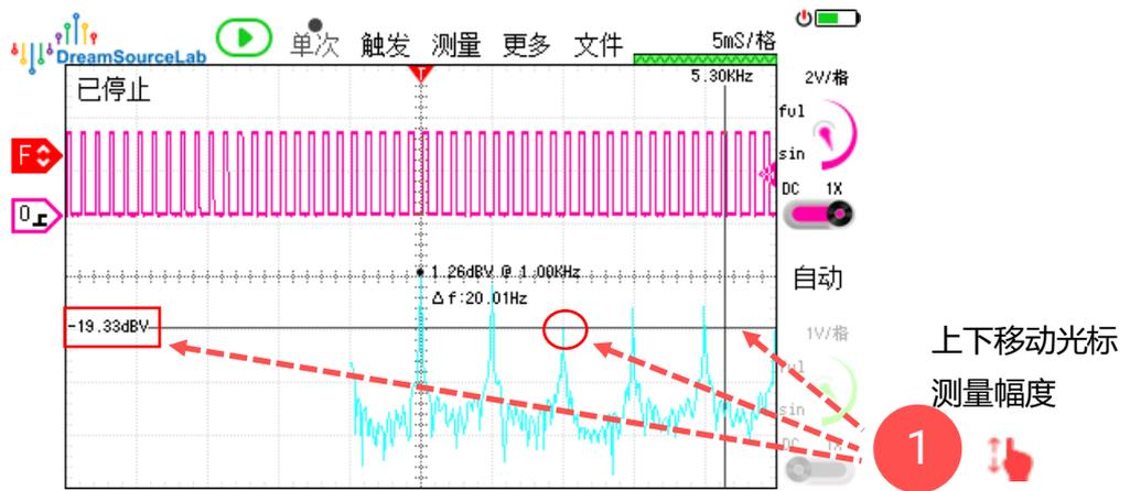
图 2-64 光标测量幅度
