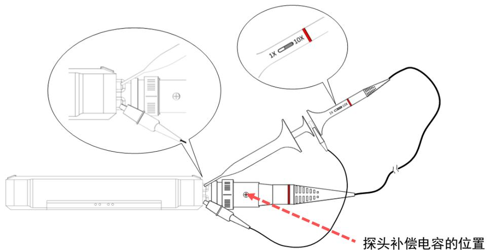
图 1-9 校正信号连接
