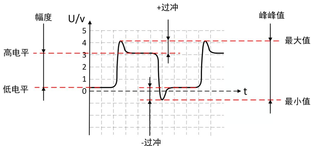
图 2-34 垂直方向测量参数图示
