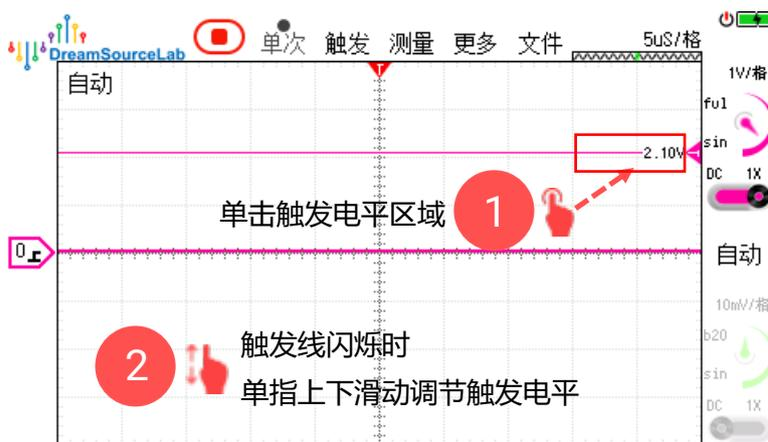
图 2-18 默认状态设置触发电平
