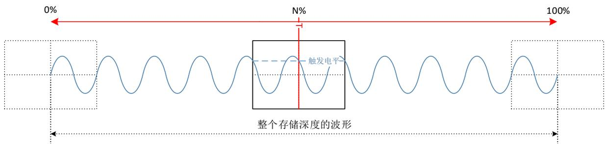
图 2-16 触发位置与存储深度
