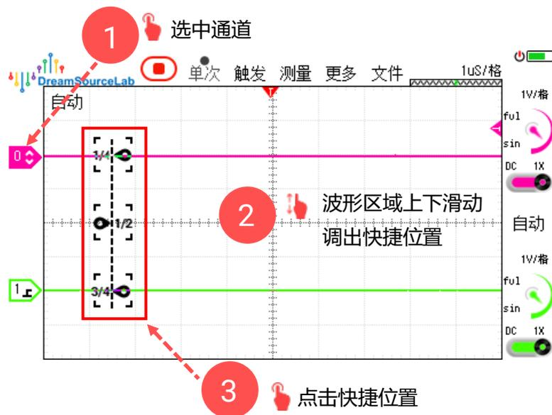
图 2-13 垂直偏置的快速定位
