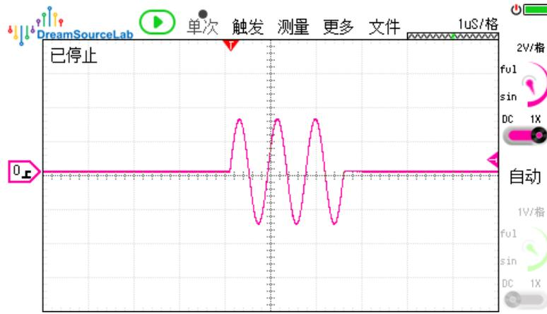
图 2-27 突发信号的稳定触发
