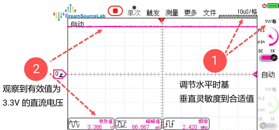
图 3-2 直流电压图
