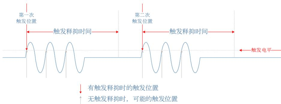
图 2-26 触发释抑的原理
