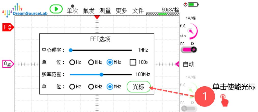
图 2-63 FFT 测量光标使能
