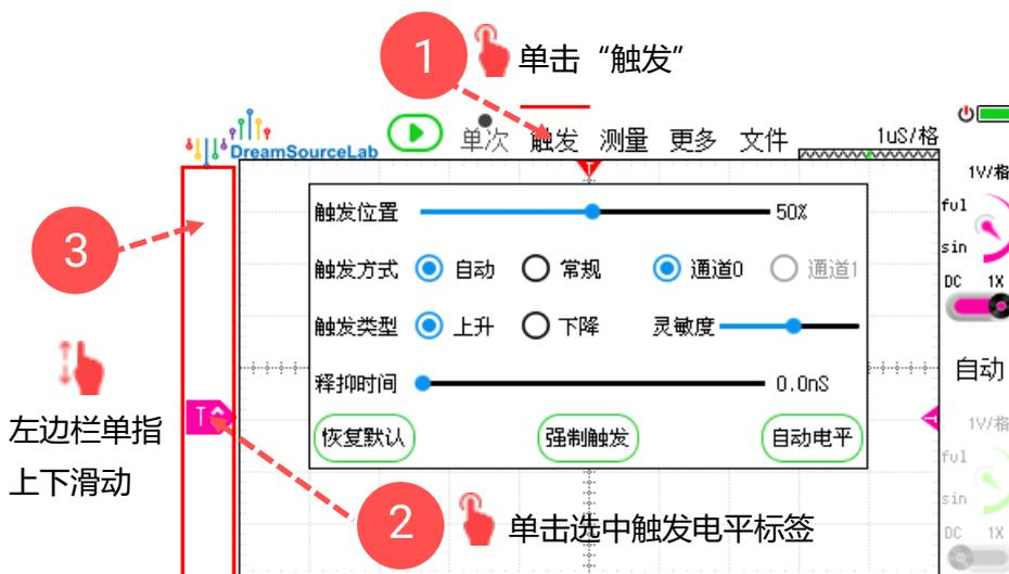
图 2-19 触发选项设置触发电平
