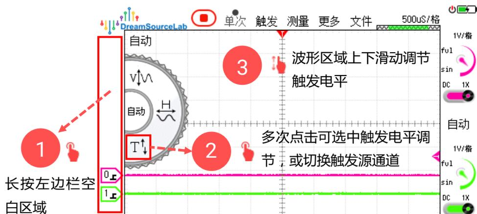
图 2-33 单手模式调节触发电平
