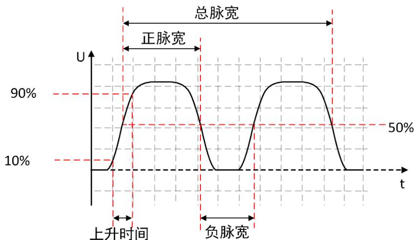
图 2-35 水平方向测量参数图示
