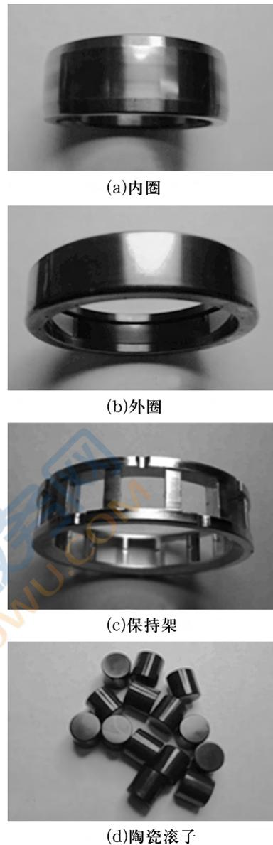
图6 试验后陶瓷滚子轴承零件外观形貌
