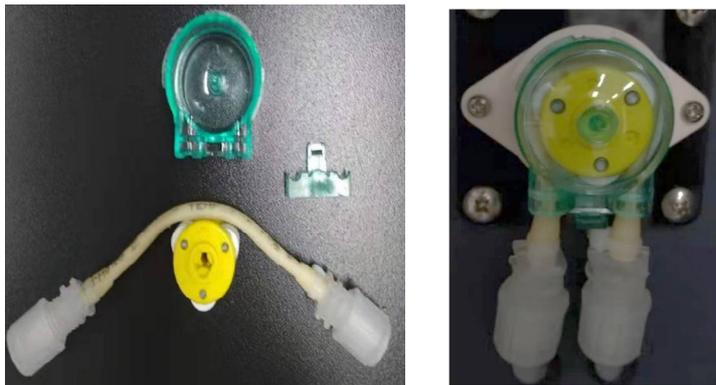
(5) 循环马达蠕动管更换: 下压保护盖左/右两边的卡榫，拆下透明保护盖
