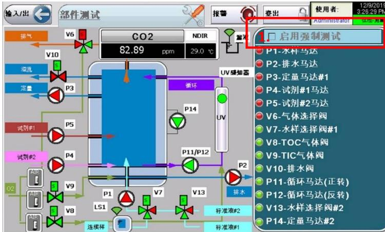
开启部件测试功能后，可选择测试部件动作(图 8-2. ①)，开启为绿色，关闭为红色。
