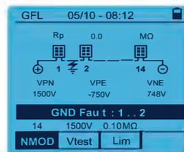
GFL (对地绝缘故障定位) 功能
