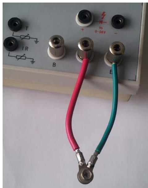
图 10：测试座接触电阻测试
