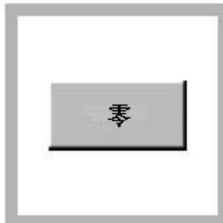
10. 按下“零”键进行仪器调零。这时屏幕将显示：0.00 mg/L N。
