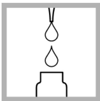
6. 取下瓶盖，分别向 2 支消解管中各添加 5mL 试剂 C 溶液。倒置 2-3 次以混合均匀。
