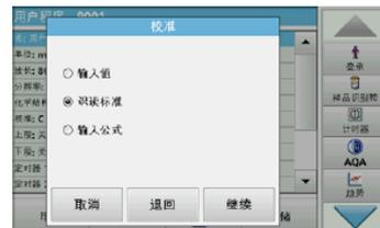
8. 选择“识读标准”进行校准。先按“+”符号，输入标准液浓度，建议配置 0.10, 0.50, 1.00, 5.00, 10.00, 15.00 mg/L 的标准溶液。
