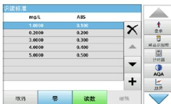
9. 首先选择第一个浓度选项，插入空白溶液，按“零”，然后依次插入经检测步骤反应完毕的对应浓度的标准溶液，按“读数”，直至所有标准溶液测量完毕。
