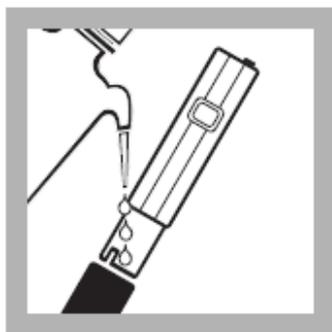
6、为了获得更快的响应速度和更长的使用寿命，要将几滴去离子水放置到保护盖中，以防止玻璃球体在使用过程中干燥。
