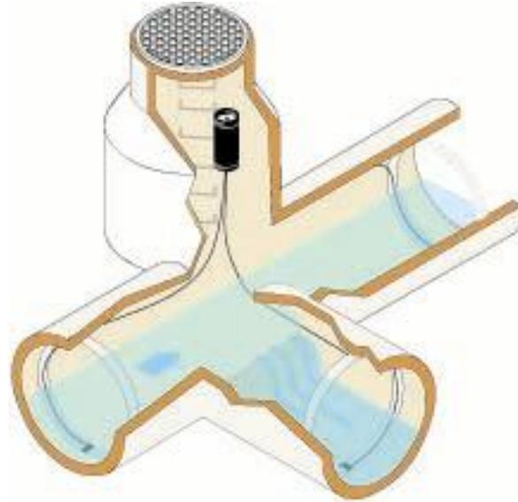
有时需要对检查井的流量测定进行多次测定和校核。在图 7 中，1 个 920 型流量计可以提供帕歇尔量水槽中的超声波流量测量，也可以使用连续性方程 ( $Q=AV$ ) 测量上游的流量。这可以确保在浸没式流量条件下不会丢失数据。
