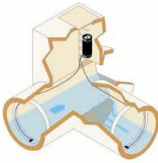
在某些情况下，有些 CSO 应用中的溢流湍流程度很强，很难进行准确的测量。图 6 显示的带有两个深度/速度传感器的 920 型流量计，它将测量上游和下游出水的流量，从而确定溢流的体积和持续时间。
