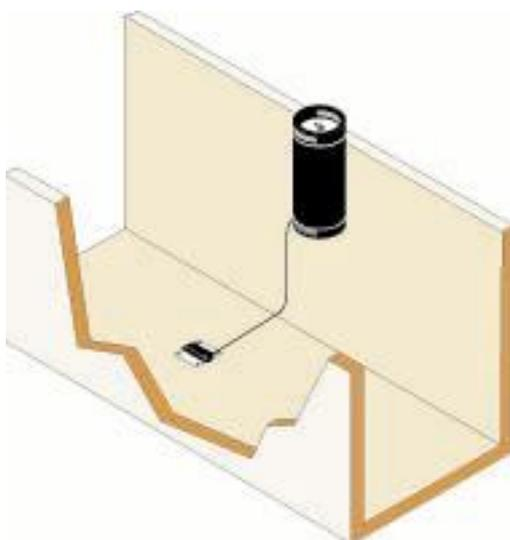
当合流管道的溢流有助于精确测量时，920 型流量计可以在主设备中测量深度和速度，在溢流通道中测量排放量，准确度可达到 $\pm 5\%$ 。见图 5。
