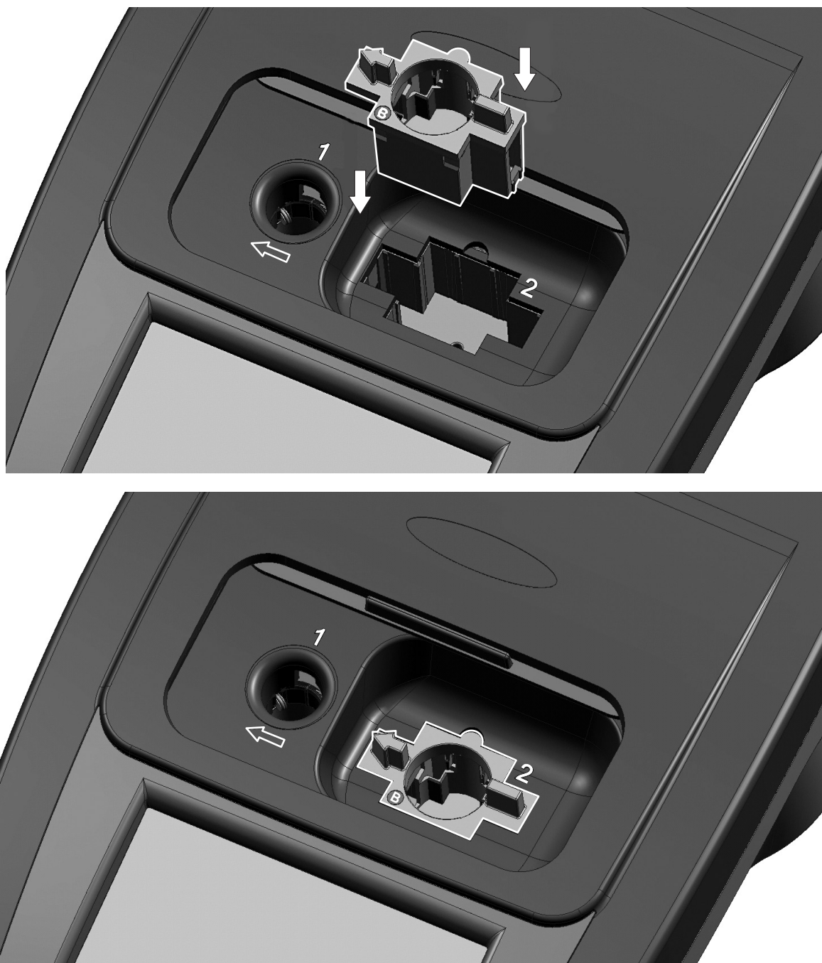
图 5 样品比色皿适配器的安装
