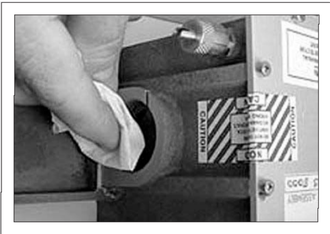
图 7-54 清洗 IR 光具座组件的蓝宝石窗
