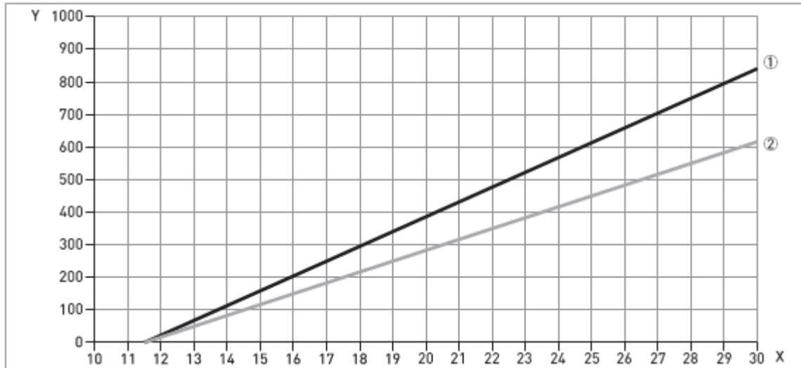
图 5-10: 非防爆及危险区域认证 (Ex i / IS / NI): 端口电流输出为 22 mA 时的最小供电电压 (开关量输出 — 继电器: 30 mA)
