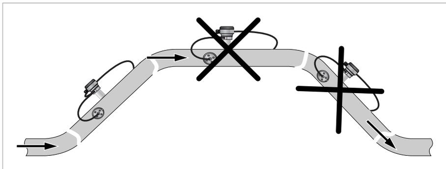
图 3-5: 在弯管上的安装
