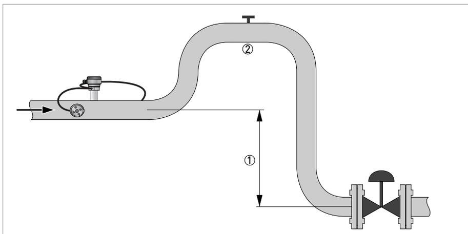
图 3-10: 长度超过 5 m/16 ft 的下行管道
