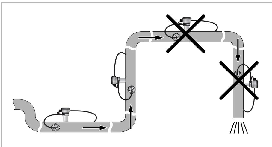
图 3-6: 在弯管上的安装
