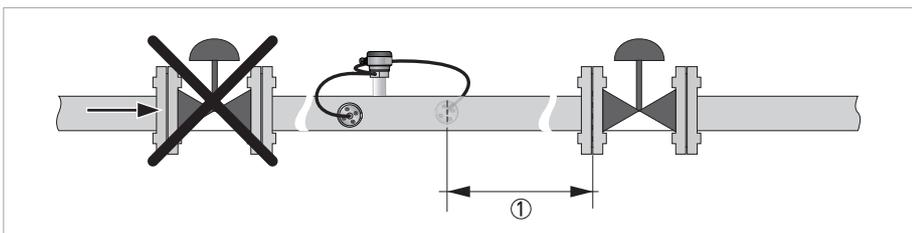
图 3-9: 安装在控制阀之前
