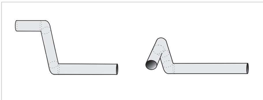
图 3-3: 当流量计上游使用了 2 维或 3 维弯头时的进口直管段
