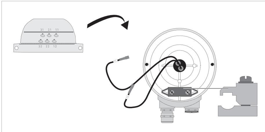
图 4-2: 将电缆接入接线盒中
