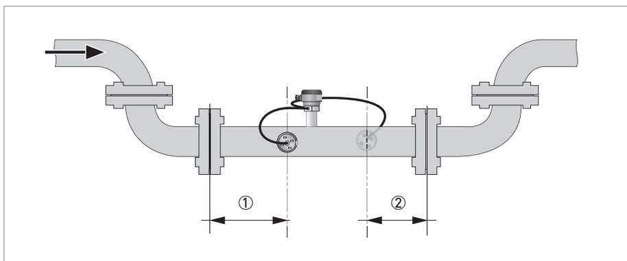
图 3-2: 建议进出口直管段
