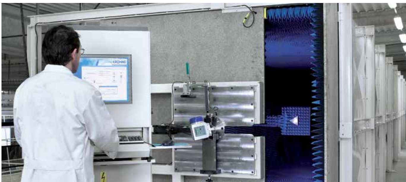
延伸式的 FMCW 雷达物位计的校准装置
