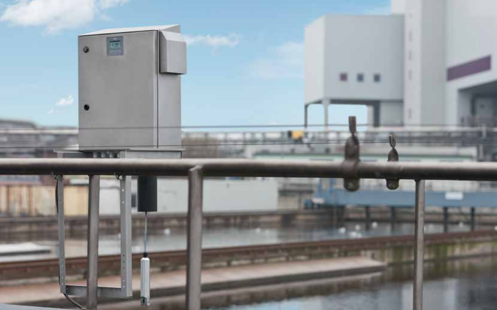
德国 克雷菲尔德污水处理厂 二级沉淀池中的污泥泥位测量
