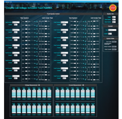
电芯故障注入操作介面
