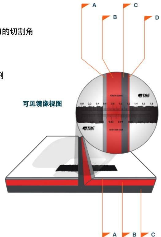
涂层厚度是通过计算刻度上的分度数，乘以所用刀具对应的D因子来获得，D因子标注在仪器上。
