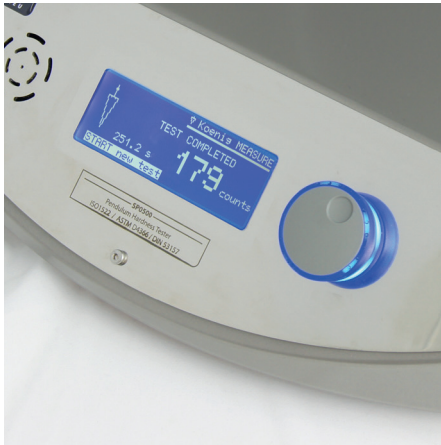
测试进行时产生视觉和声学信号
