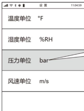
压力单位: hPa、mbar、bar、psi、Pa、kPa、mmHg、inHg、mmH2O、inH2O、atm、torr, 按确认键可切换
