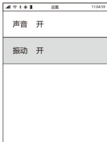
声音：声音/ 振动，按确认键切换“开”、“关”
