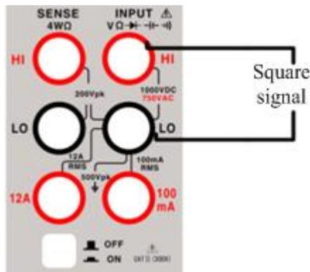
图 2.7.2 五位半占空比测量端子连接
