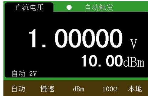
图 6-7 dB 参考电压修改界面
