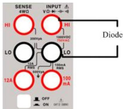
图 2.6.2 二极管测量端子连接
