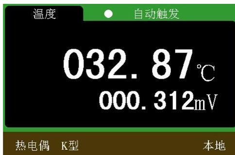
图 6-16 K 型热电偶测温
