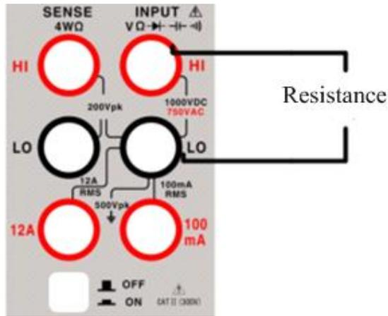
图 2.3.2 2W 电阻测量端子连接
