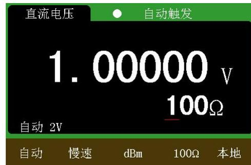
图 6-8 dBm 参考电阻修改界面
