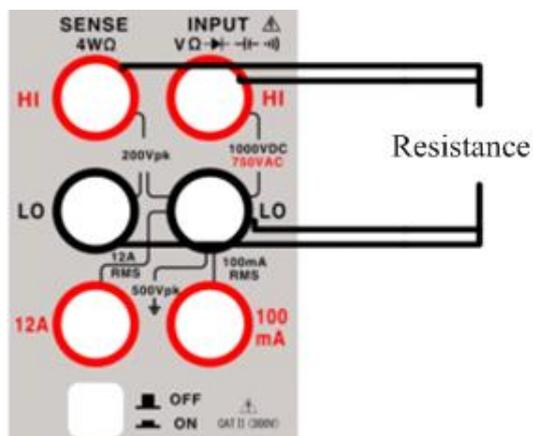
图 2.3.4 4W 电阻测量端子连接
