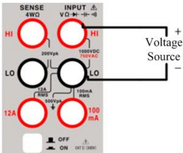
图 2.1.2 DCV 端子连接
