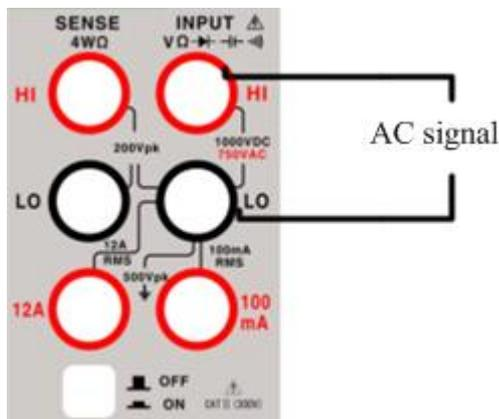
图 2.5.2 频率/周期测量端子连接
