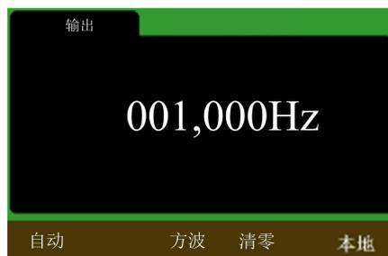
图 2.8.1 默认输出 1kHz 频率方波界面
