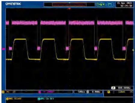
实际波形-AC-INT 模式，频率 900 Hz，TrgOut 宽度 1.1 ms
