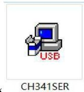
点击图标“CH341SER”，打开驱动安装软件，弹出图 4.7.1，点击**安装**键，开始自动安装，安装完成后显示图 4.7.2，按确定键完成安装并退出。
