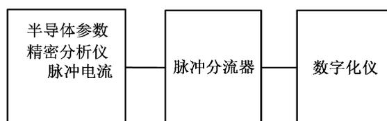
图 10 脉冲电流校准连接框图
