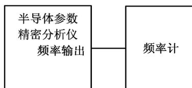
图 11 频率校准连接框图
