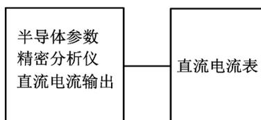
图3 直流电流输出 $\pm(10 \text{ } \mu\text{A} \sim 10 \text{ A})$  校准连接框图
