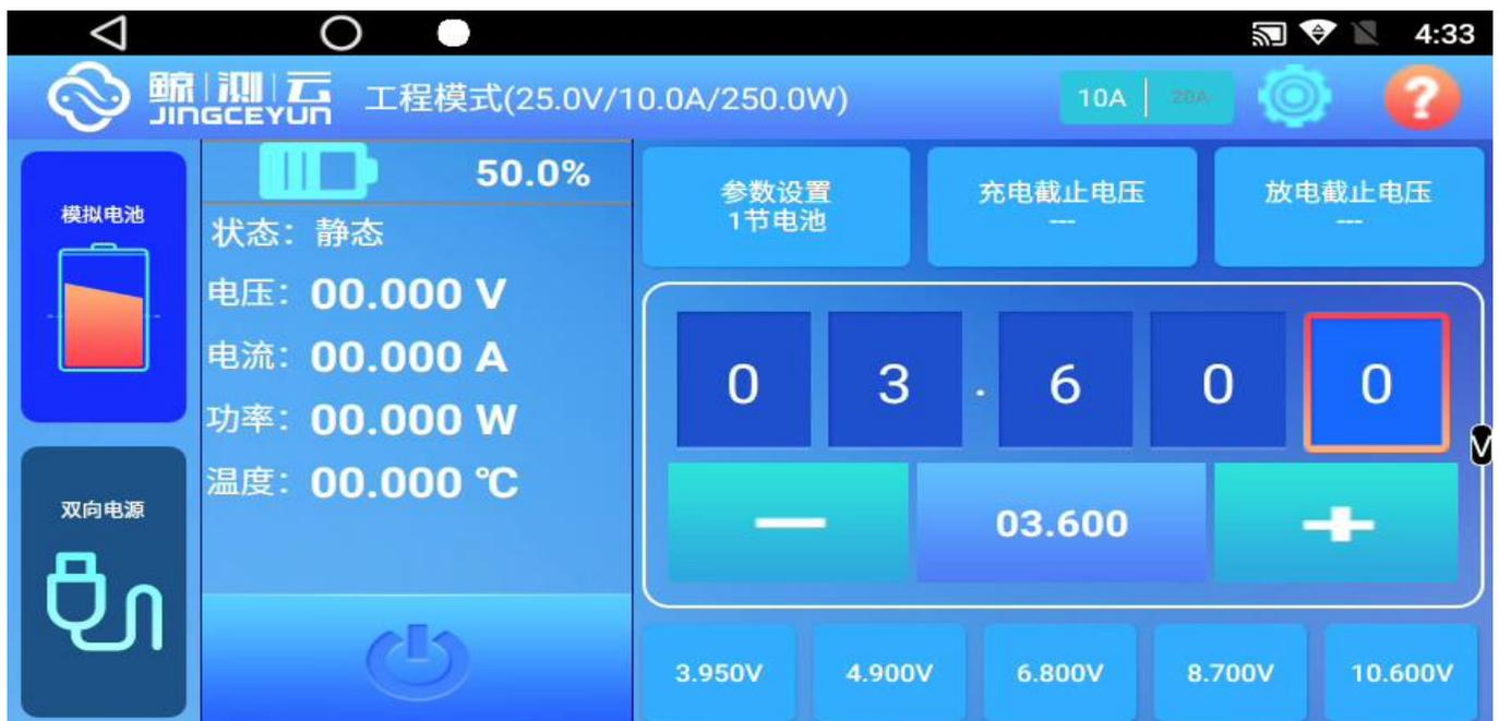
系统会自动设定到设定电压范围的50%值，接上PCBA的正负极后，就可以看到PCBA的实时静态电流，如果正负极接反，输出按钮会立刻关闭，防止烧坏PCBA
