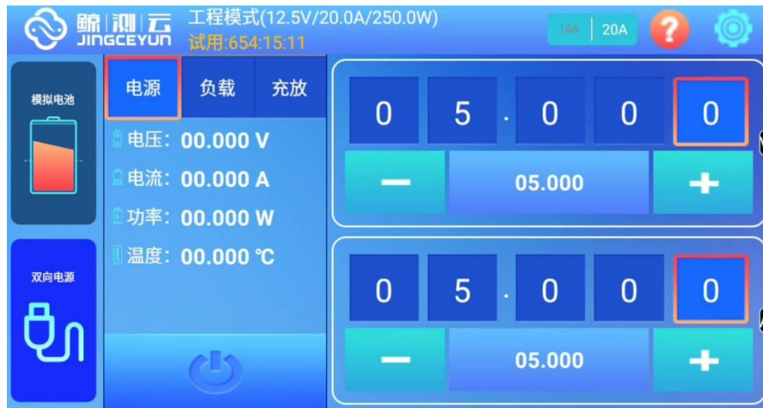
2. **负载模式**，可设置CC/CV两种模式，精度都可以设定到1mA/1mV，电压最大48V，电流最大10A
