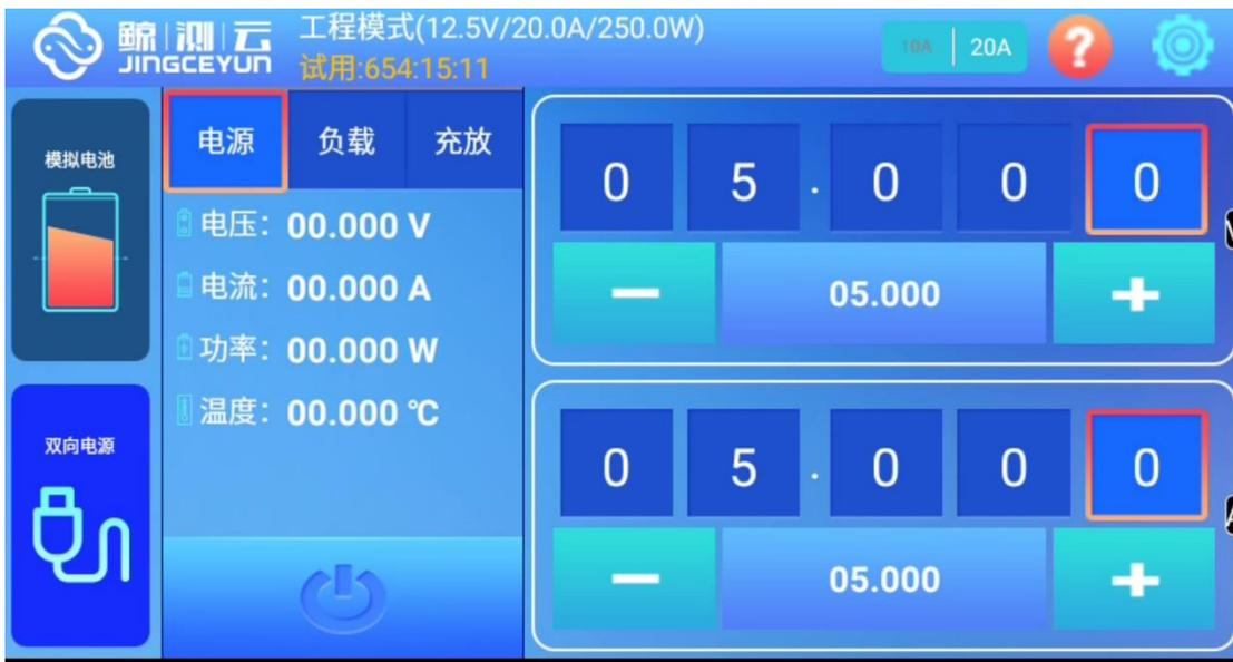
2. **负载模式**，可设置CC/CV两种模式，精度都可以设定到1mA/1mV，电压最大48V，电流最大10A
