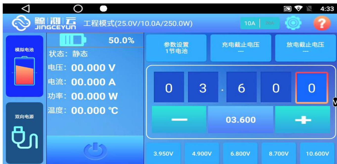
系统会自动设定到设定电压范围的50%值，接上PCBA的正负极后，就可以看到PCBA的实时静态电流，如果正负极接反，输出按钮会立刻关闭，防止烧坏PCBA
