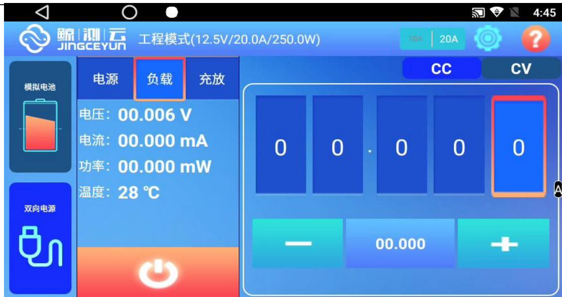
**2. 充放电模式：**可充放电自由切换，适合用给电池包测试充放电循环，测试电池包的性能，可上传到鲸测云平台获得更多测试信息
