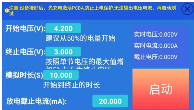
可模拟两种电压截止点，放电截至电压和自耗电截至电压
