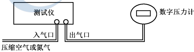
图 2 测试仪压力校准连接图
