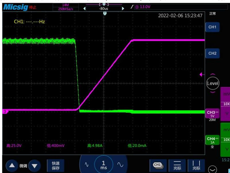
纹波测试: 25V 输入/输出, 5A负载模式下, 纹波有效值50mV左右
