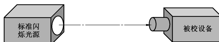
图 5 显示器闪烁/响应时间测量仪校准原理示意图
