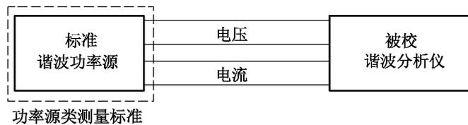
图 B.3 功率源类测量标准校准谐波分析仪接线示意图
