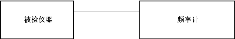
图 1 频率误差检定连接示意图
