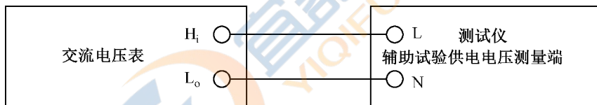
图7 带试验电压源输出的试验电压示值误差测量设备连接示意图
