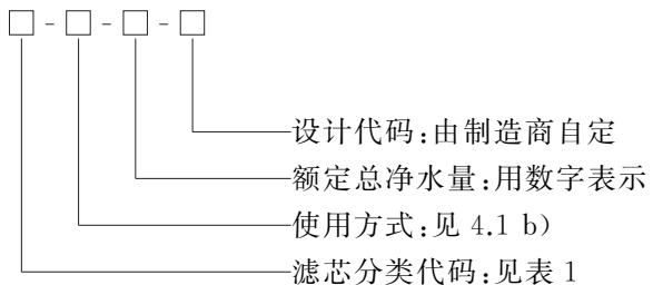
示例：UF-NI-3000-1011 表示为：总净水量为 3 000 L，非一体式设计序号为 1011 的超滤膜滤芯。
