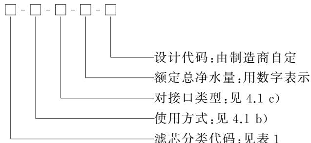
示例：UF-I-X-2000-802 表示为：额定总净水量为 2 000 L，设计序号为 802 的一体式旋转超滤膜滤芯。
