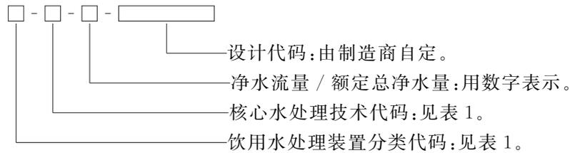
示例 1:反渗透净水器 CJC-RO-0.78/2000-A01 表示为净水流量 0.78 L/min、额定总净水量 2 000 L、设计代码为 A01、采用反渗透膜作为核心水处理技术的纯净水处理器。
