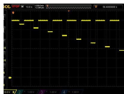
ISO16750-2 降压重置试验曲线
